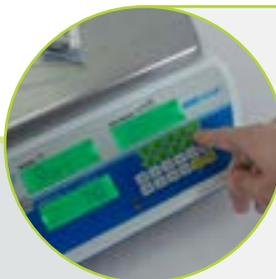
La serie Cruiser CCT le permite almacenar hasta **140 PLU** (Price Lookup, por sus siglas en inglés) en su memoria para recuperar rápidamente el peso de la pieza de un artículo determinado en lugar de obtener primero el peso/conteo de la muestra.
