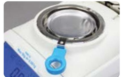
El elevador de bandeja permite colocar y retirar fácilmente las muestras
