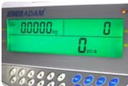
Pantalla LCD retroiluminada indica el peso, la unidad de peso y conteo de piezas
