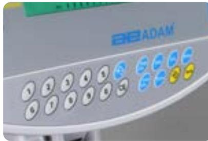
Teclado numérico completo que facilita la configuración de los límites de pesaje de control
