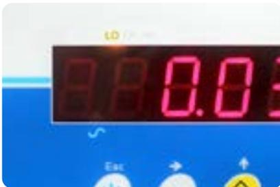
Las luces de comprobación de peso se encienden para indicar el pesaje de control
