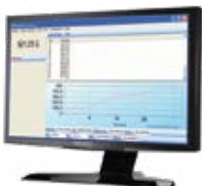
AdamDU recopila información de hasta ocho balanzas Adam simultáneamente, a través de conexiones RS-232 o USB. Una interfaz fácil de utilizar con una ventana de comandos principales, le permite a los usuarios ver y administrar las sesiones de captura de datos.
